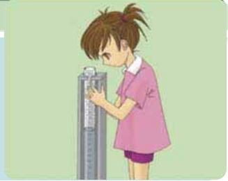
透視度は、水の濁り具合を表し、視覚的に捉えやすい項目です。透視度計（クリンメジャー）を使って調べましょう。透視度計が手に入らない場合は、アクリルパイプなどを加工して自作し、使用しても良いでしょう。透視度計のパイプに川の水を入れ、直射日光を避け、十字二重線のついた標識板をパイプ中で上下させ、十字二重線がはっきり見えた時の水深がその水の透視度になります。
