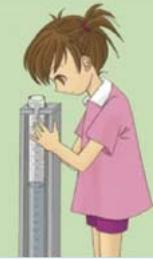
透視度は、水の濁り具合を表し、視覚的に捉えやすい項目です。透視度計（クリンメジャー）を使って調べましょう。透視度計が手に入らない場合は、アクリルパイプなどを加工して自作し、使用しても良いでしょう。透視度計のパイプに川の水を入れ、直射日光を避け、十字二重線のついた標識板をパイプ中で上下させ、十字二重線がはっきり見えた時の水深がその水の透視度になります。
